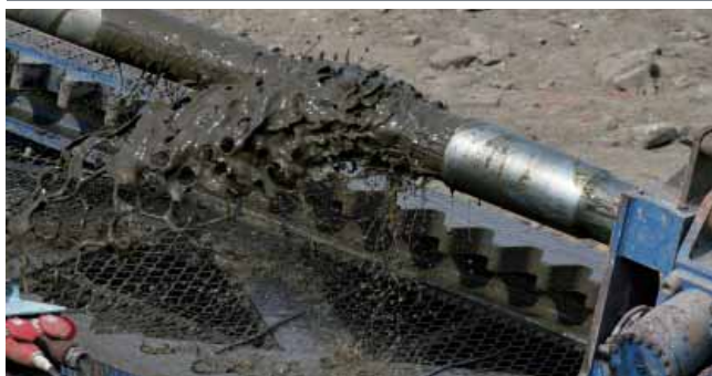
Fot. 8. Moment rozkręcania żerdzi płuczkiwowych 6 5/8”.
